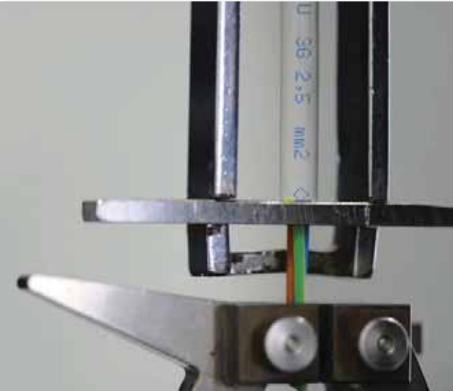
Sıyırma testi altındaki bir numune.
