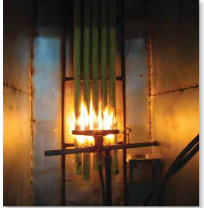
Demetlenmiş kabloların yanması testindeki bir kablo numunesi.
