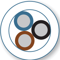
Dış kılıf et kalınlığı için kesit görünümü.
