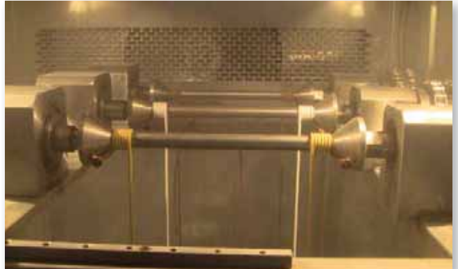
Döngüsel dayanım testindeki kablo numuneleri.
