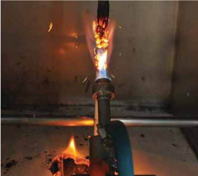
Yanan damlacık testindeki olumsuz bir kablo numunesi.
