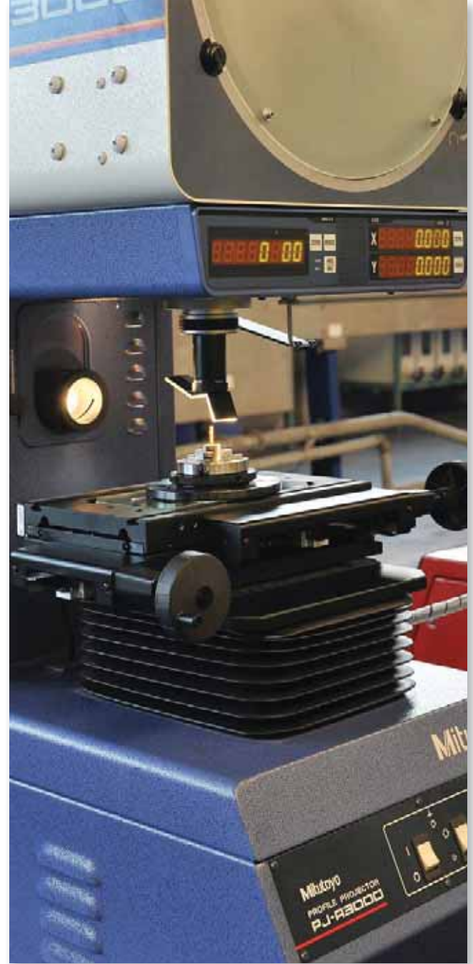
Profil projektör ile geometrik ölçümler yapılır.
